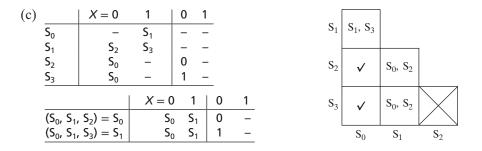
Maximal Compatibles:  $(S_0, S_1, S_2)$ ,  $(S_0, S_1, S_3)$
